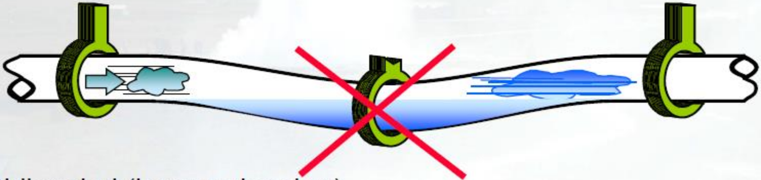
Su Birikmeleri (boru sarkmaları)
