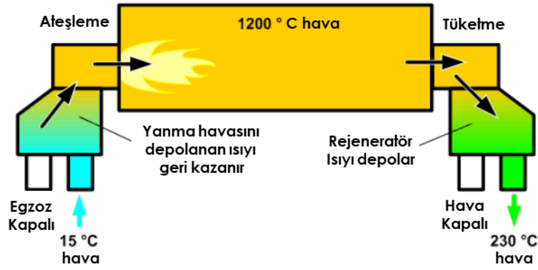
Şekil 5-6: Rejeneratif Brülörün 1. Döngüsü
