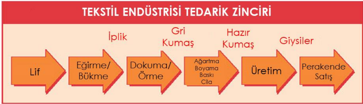
Şekil 5-34: Çeşitli Tekstil Proseslerinin Akış Şeması 124
