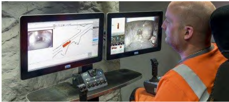
Şekil 18: AutoMine Uygulaması ile Uzaktan Kontrol
